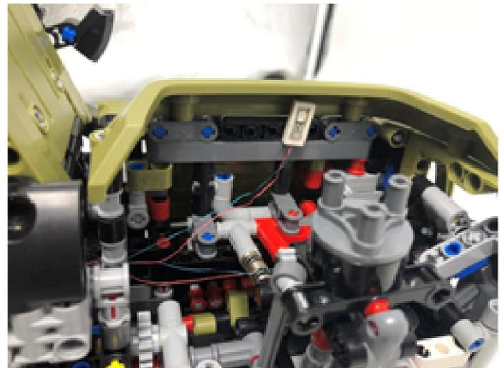
Installieren Sie die kreisförmige Lichtgruppe von unten in die Scheinwerferposition
